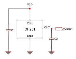
注: C1 推荐使用 10nF, C2 推荐使用 100pF, 可有效滤除电源和信号对地的噪音, 同时可有效降低芯片被静电击穿的风险。
