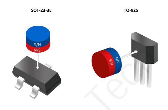
如上图, DH251 产品对磁感线由芯片底部垂直向芯片顶部穿过的磁场和由芯片顶部垂直向芯片底部穿过的磁场都敏感。以丝印面为正面,DH251, SOT-23-3L 封装对 N/S 两极磁场均敏感; TO-92S 封装对 N/S 两极磁场均敏感。
